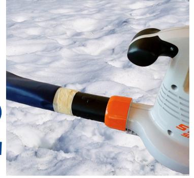
Gebläse am Befüllschlauch anschliessen & Iglu Former© aufblasen.
